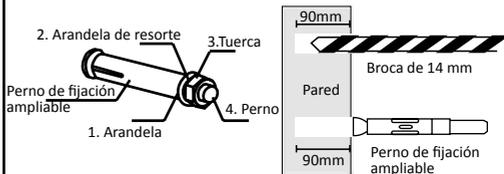
El perno debe sobresalir de la pared para poder sujetar el soporte de pared (Ver paso 3)
